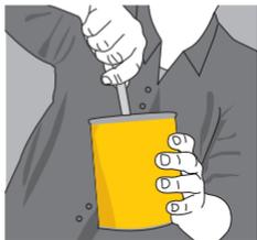
Mezcla por separado los **componentes A y B** de Sikadur®-31 Adhesivo.
