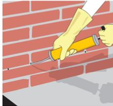
Elimine el polvo de cada perforación con una bomba de aire.
