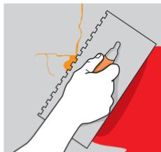
Después de secar, recubre la superficie con un mortero impermeabilizado (cemento, arena, agua y Sika®-1 ó SikaTop®-121).
