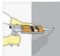
Inyecta Sika AnchorFix® 3001 desde el fondo, llenando solamente hasta tres cuartos de la perforación.
