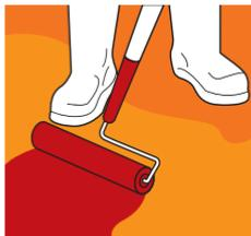
Aplica el primario de **Sikafloor®-155 WN** mediante brocha o rodillo, o bien mediante llana lisa o jalador y extiéndelo después con rodillo para uniformizar el espesor.
