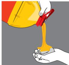
Mezcla rápidamente (10 segundos) dos partes de cemento con 1 parte de Sika®-2.
