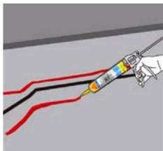
Forma un canal sobre la grieta con un sellador **Sikaflex® 1a**, cemento o yeso.
