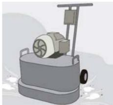
Preparación de superficie de concreto, retira la superficie mal adherida y limpia.
