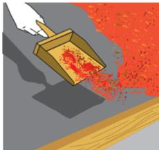
Riega **Sika® Chapdur** a razón de 2Kg/ m<sup>2</sup> sobre el concreto fresco en cuanto desaparezca el agua de exudación.
