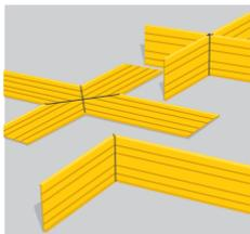
La **Sika® Banda de PVC** permite hacer diferentes soldaduras en "T", en "L" o en "Cruz", para unir la banda utiliza la **Sika® Plancha GSK 213** o **GSK 214**, en la cual solo tienes que unir cada extremo de la banda a la plancha hasta que se funda, retirar la plancha y unir con presión manual evitando que queden poros o protuberancias.
