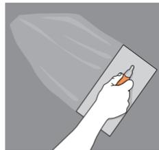
Aplica la primera capa de 2 mm. de espesor de **Sikalastic® -152 MX** con llana dentada.
