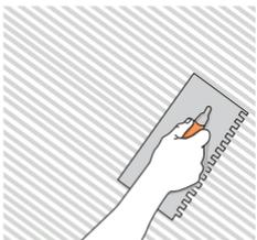
Aplique el adhesivo sobre la superficie con una llana dentada en una sola dirección. Coloque la pieza presionando hasta obtener la ubicación deseada.
