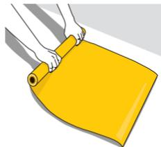
El sistema se aplica flotado sobre la plantilla antes de colocar el acero de refuerzo y de colar el concreto, de tal manera que el lado arenado se adherirá a la estructura evitando la migración lateral y protegiendo el concreto, en el caso del muro colocar la membrana sobre la cimbra antes de habilitar el acero y colar el concreto. Para las terrazas colocar la membrana después de aplicar el primario y posteriormente aplicar el piso o acabado de la terraza, nunca dejar expuesto a los rayos UV.
