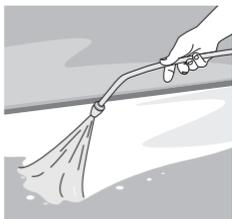
Cure solo con **Antisol® Pro**, entre capas cure con agua y proteja de una deshidratación temprana.
