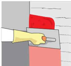
Aplica en capas sucesivas de 2 cm máx. hasta lograr el espesor deseado. Afina con llana metálica o de madera.
