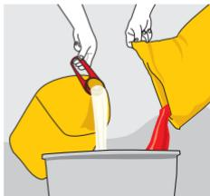
En un recipiente coloca el **componente A** (líquido) y vacía el **componente B** (polvo) en forma gradual y mezcla hasta obtener una pasta.
