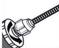
Deslizar la tapa del tornillo sobre la boquilla del mezclador de resina de inyección y conectarlo al cartucho con ese movimiento.
