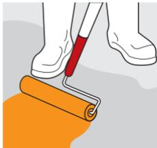
Aplicación de primario de **SikaLatex® N** diluido dos partes de agua por una de **SikaLatex® N**.
