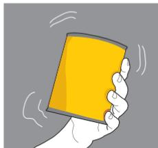
Agita los **componentes A y B** por separado. El **componente A** tiende a sedimentarse, asegúrate de mezclarlo bien con taladro de bajas revoluciones.
