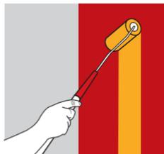
Aplica una capa base de **Sikagard®-403 W** con airless o con rodillo.
