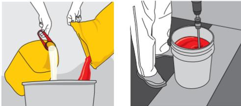
Coloca todo el contenido del **componente A** en una cubeta y después agrega poco a poco el contenido del **componente B**. Mezcla con taladro por unos minutos para obtener una mezcla uniforme.
