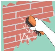
Retirar el recubrimiento del muro que presente el daño por salitre.
