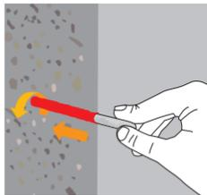
Introduce la varilla o el perno, girando suavemente y siempre en sentido antihorario y retirando el exceso de producto inmediatamente.
