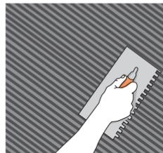
Se aplica con una llana dentada. Aplique suficiente producto para asegurar un cubrimiento completo de la parte posterior de la pieza a adherir.
