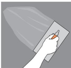
Aplica rápidamente con llana o una cuchara húmeda, introduce una varilla limpia en varias ocasiones para ayudar a compactar el material.
