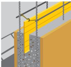
Para que la banda mantenga su posición durante el vaciado del concreto, elabora argollas con alambre grueso para sujetarla.
