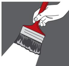
Aplique SikaWall® 401 Acril Muro diluido 1:3 (producto: agua) en volumen. Deje secar hasta 4 a 6 horas.\*\*
