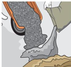
Calcula la cantidad necesaria de **Sikalite®** de acuerdo con la cantidad de cemento utilizado en la mezcla. Agréguelo junto con la grava y la arena si es concreto o a la arena si es mortero, previo a la adición de agua.
