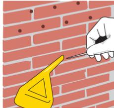
Perfora la punta de los envases de **Igol® Infiltración** con una punta caliente.
