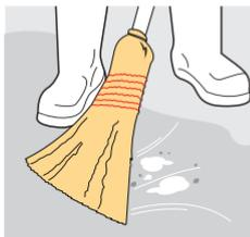
\*Dentro de las 12 a 14 horas posteriores a la aplicación, use una manguera de jardín de baja presión y una escoba rígida para quitar la pasta de la superficie retardada. No use fuerza excesiva en la extracción ya que esto puede socavar el perfil del agregado expuesto.
