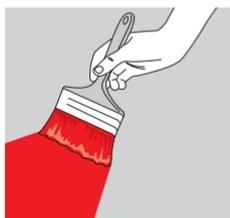
Tapa los orificios y huecos grandes (> 12-15 mm) antes de la instalación del Sistema **SikaBit® S-515 SGMX** ya que el sustrato para la membrana **SikaBit® S-515 SGMX** necesita suficiente estabilidad para evitar movimientos durante los trabajos de construcción. En algunos casos requerirá primario y en otros caso solo se aplica flotado (es decir sin quitar la protección del autoadhesivo).
