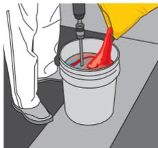
Vierte gradualmente el componente B (polvo) y mezcla<sup>(1)</sup> hasta obtener una mezcla sin grumos, ni aire.
