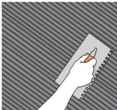
Aplice el adhesivo sobre la superficie con una llana dentada en una sola dirección. Coloque la pieza presionando hasta obtener la ubicación deseada.
