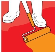
Aplica nueva capa de **Sikalastic®-560** a razón de 0.5 L/m<sup>2</sup> de forma perpendicular a la capa anterior. Si deseas mayor durabilidad (15 años) aplica una 3ra. capa de **Sikalastic®-560** a razón de 0.5 L/m<sup>2</sup>.
