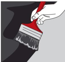
En concreto siempre coloca como base un primario asfáltico.
