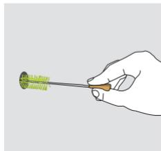
Limpija la perforación con cepillo de metal y una bomba de soplado o compresor (\*).
