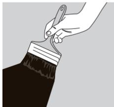
Aplica el primario asfáltico, utilizando un cepillo, cuando se utilice **Emulsika® Primer** (primario base agua), diluido en relación 1:3 (3 PV agua por 1 PV primer), El Primario asfáltico, ya sea base agua o base solvente, se aplica con un rendimiento de 4 a 6 m<sup>2</sup>/L, de acuerdo a la porosidad del sustrato evitando que forma una costra, esperar a que seque antes de continuar el sig. paso.
