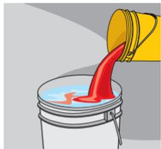
Agregue **Sikament®-100 MX** en el último 10% del agua de mezcla durante la preparación del concreto.
