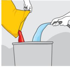
Mezcla 3 partes de **Sika®-101**, con una parte de agua (en volumen) y deja reposar 5 minutos.
