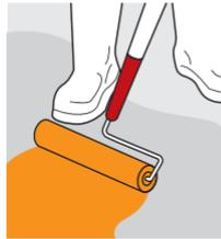
Aplica una capa de **Acril Techo® Rápido** sin diluir en toda la superficie con un mínimo de espesor de 0.5 mm por capa y déjalo secar 2 horas.
