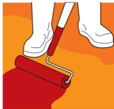
Aplica **Sikalastic®-560** sin diluir en toda la superficie con un espesor máximo por capa de 0.5 mm y déjalo secar de 12 a 24 horas.
