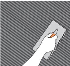
Aplique el adhesivo sobre la superficie con una llana dentada en una sola dirección y coloque la pieza suavemente hasta obtener la ubicación deseada.
