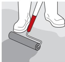
Aplica **Sikafloor® 155 WN** como primario sobre concreto a razón de  $0.2 \text{ L/m}^2$ <sup>(\*\*)</sup>.
