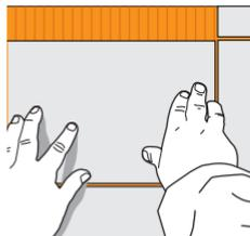
Coloque la pieza presionando hasta obtener la ubicación deseada.
