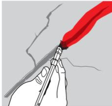
En fisuras menores a 0.7 mm y sin movimiento, limpie perfectamente, selle y aplique una capa de SikaWall® 401 Acril Muro sin diluir. Deje secar por 12 hrs.\*
