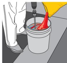
Agrega el **comp B** dentro del **comp A** y mezcla por 1 minuto con taladro de bajas revoluciones hasta homogeneizar la mezcla. Evita agregar burbujas de aire a la mezcla.
