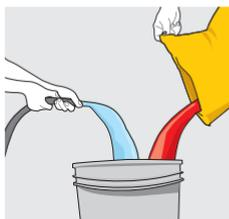
Mezcle un saco de **SikaCeram®-256 Flex** con 4.5- 5 L. de agua. Mezcle por 3 minutos y deje reposar por 5 minutos.
