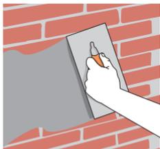
Colocar nuevamente el recubrimiento en el muro reparado.
