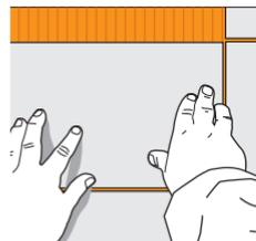
Si coloca una plantilla de mosaico veneciano, distribuya con una llana lisa o con la parte lisa de la llana dentada una capa uniforme de SikaCeram®-252 Pool y sobre el sustrato una capa con la llana dentada y después coloque la plantilla ejerciendo presión sobre el adhesivo colocado en el sustrato.
