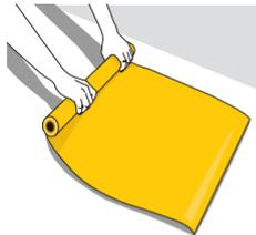
Colocar el adhesivo o pasta del piso encima de la membrana en la parte arenada, enseguida colocar su piso de acabado.
