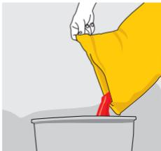
Vacia **SikaGrout® Constructor** de forma gradual y mezcla constantemente. Evita dejar grumos.
