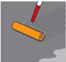
Pásale rápidamente un rodillo de puntas de nylon para expulsar las burbujas de aire atrapado.
