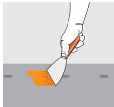
Aplica inmediatamente **Sikadur® -31 Adhesivo** con espátula o llana en una perforación limpia, asegurando un relleno correcto.
