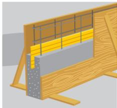
Coloca la **Sika® Banda de PVC**, embebida en el concreto de primera etapa, centrada perimetral y perpendicularmente.
