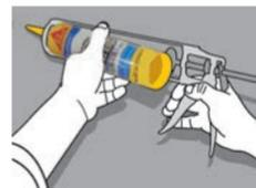
Coloca el fondo de junta **SikaRod®** del ancho adecuado a todo lo largo. Corta la boquilla del cartucho dependiendo del ancho requerido. Perfora la membrana de protección, colócalo en la pistola de calafateo y aplícalo. Para salchichas usa la pistola universal Sika.
