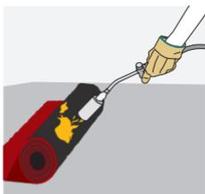
Aplica el **Sika® Manto**, aplicando calor por medio de soplete en la cara inferior, hasta fundir la película transparente y logrando que el asfalto se adhiera a la superficie imprimada.
