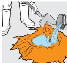
Agrega el agua de amasado y mezcla bien el mortero o concreto. Aplícalo y cúralo con agua o **Sika® Curador**.
