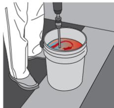
Verter todo el endurecedor (**comp. B**) en el recipiente de la pasta (**comp. A**) y mezclar con un taladro eléctrico de baja velocidad (~ 500 rpm) hasta que el material sea totalmente homogéneo.
