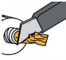
Corte el extremo de la película protectora y enrosque la boquilla mezcladora.
