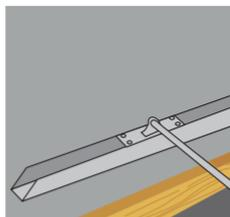
**Sika®Level-325** se acomoda con escantillón y llana dentada para detalles.
