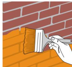
Prepara una lechada de cemento con la dilución de **Sika®-1** y aplícala saturando la superficie.
