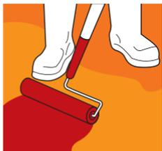
Como acabado: Aplica 1 ó 2 capas de **Sikafloor® 264**, utilizando un rodillo de felpa de pelo corto de 3/8" resistente a solventes.
