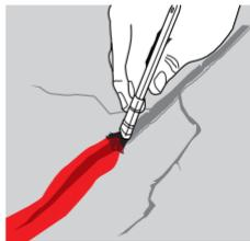
Si vas a impermeabilizar con **Sika® Manto** sella las grietas con **Permalastik®**, alisa con un cuchara de albañil. Si impermeabilizas con **Emulsika®** sella las fisuras abriendo caja y con **Sikaflex® 1a**.
