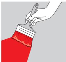
Tapa los orificios y huecos grandes (> 12-15 mm) antes de la instalación del Sistema **SikaBit® A-520 SGMX** ya que el sustrato para la membrana necesita suficiente estabilidad para evitar movimientos durante los trabajos de construcción solo se aplica flotado.
