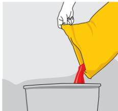
Vierte gradualmente el **componente B** (polvo) y mezcla hasta obtener una mezcla sin grumos.
