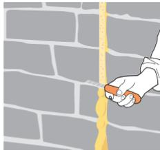
Después que haya secado corta el exceso de la espuma.
