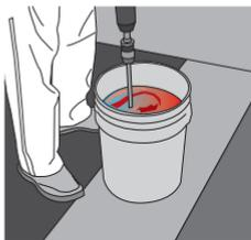
Mezcla durante 1 minuto con un taladro de bajas revoluciones (300-400 rpm) hasta homogeneizar la mezcla. No agregues burbujas a la mezcla.
