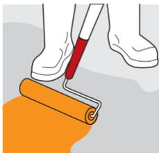
Aplica la dilución de **Sikalastic®-560** con rodillo a razón de 0.125 a 0.250 L/m<sup>2</sup> con 10% de agua y deja secar de 2 a 4 hrs.\*
