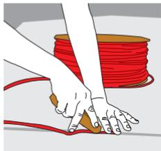
Instala **SikaRod®** para evitar la adherencia del **Sikaflex® 1C SL** al fondo de la junta.
