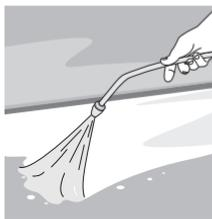
Aplica una capa uniforme de **Sika®CuraSellador STD** inmediatamente después de que desaparezca el brillo superficial en el concreto o mortero. Puedes aplicarlo con brocha, rodillo o aspersor genérico (para obtener mayor rendimiento).
