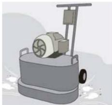
Prepara la superficie, limpiando el área con disco de diamante o carda metálica.
