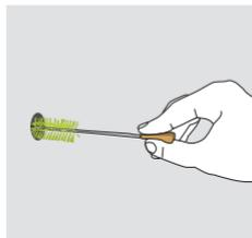
Limpia la perforación con cepillo de metal y una bomba de soplado o compresor (\*).
