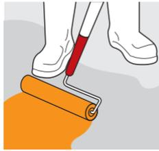
Para impermeabilización: usar como primer **Acрил Techo® 5 Ultra** diluido con agua 3:11 capa de .6 lts/m<sup>2</sup>.
