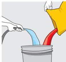
Mezcle un saco de **SikaCeram® -224 Porcelanato** con 4.5- 5 Litros de agua. Mezcle por 3 minutos y deje reposar por 5 minutos.
