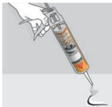
Monta el cartucho en la pistola y presiona hasta que los dos componentes del adhesivo se mezclen. No uses este material.
