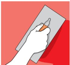
Aplica **Sika® Estuka Acrílico M o F** con una llana metálica o rodillo dejando un espesor de 1 a 1.5 mm.
