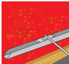
Compáctalo con llana de magnesio para una adecuada penetración frotando suavemente.
