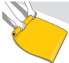
El sistema se aplica flotado sobre la plantilla antes de colocar el acero de refuerzo y de colar el concreto, de tal manera que el lado arenado se adhiera a la estructura evitando la migración lateral y protegiendo el concreto, en el caso del muro colocar la membrana sobre la cimbra antes de habilitar el acero y colar el concreto, nunca dejar expuesto a los rayos UV.
