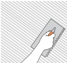
Aplique el adhesivo sobre la superficie con una llana dentada en una sola dirección y coloque la pieza presionando hasta obtener la ubicación deseada.
