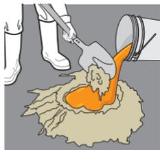
Agrega la dilución a la mezcla de la lechada, del mortero o del concreto.
