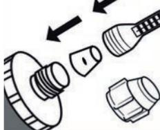
Coloque el enchufe de salida del cartucho en la punta del cartucho; posteriormente, colocar la boquilla mezcladora de resina de inyección en el cartucho.
