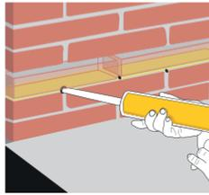
**SikaMur® Injecto Cream-100** formará una barrera impermeable evitando que la humedad ascienda por el muro.
