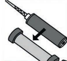
Coloque el cartucho en la pistola de aplicación lista para usar y extruir hasta que salga la mezcla (no usar hasta mezclar).
