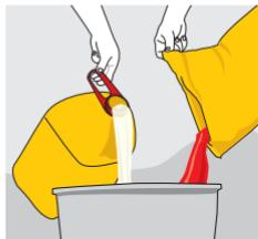
Mezcla en un recipiente limpio coloca el componente A (líquido) y vacía el componente B (polvo) en forma gradual, hasta obtener una pasta homogénea sin grumos.
