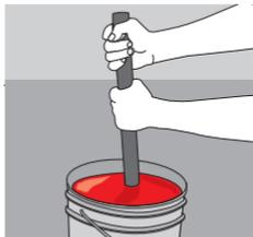
Mezcla y agrega, el líquido restante del **componente A**, hasta obtener la consistencia deseada.
