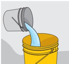
En un recipiente de boca ancha vierte el agua de mezcla conforme a la consistencia requerida para aplicarlo\*.
