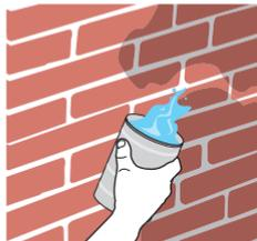
Limpia la superficie de polvo, grasa, desmoldantes, pintura, etc. y húmedécela.
