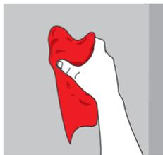
La superficie debe estar nivelada, limpia, libre de polvo, grasa o cualquier material que impida la adherencia del producto. Para aplicaciones sobre cerámica existente, debe realizarse una buena limpieza y el retiro de cualquier material que pueda interferir con la adherencia del **SikaCeram®-256 Flex**.
