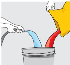
Mezcle un saco de **SikaCeram®-222 Cerámico** con 4.0- 4.6 L. de agua. Mezcle por 3 minutos y deje reposar por 5 minutos.
