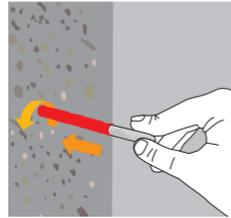
Introduce la varilla o el perno, girando suavemente y siempre en sentido antihorario y retirando el exceso del producto inmediatamente.
