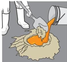
Agregue **Sikament®-100 MX** al concreto ya mezclado. En este caso debe ampliarse el tiempo de mezclado, hasta que quede el concreto homogéneo.
