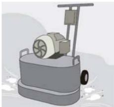
Preparación de superficie de concreto, retira la superficie mal adherida y limpia.
