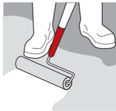
Aplica 2 capas del poliuretano alifático, utilizando un rodillo de felpa de pelo corto de 3/8" resistente a solventes.
