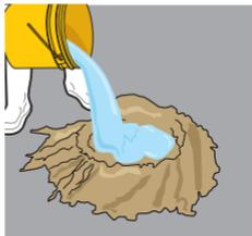
Agrega el 80% del agua de la mezcla a toda la arena.
