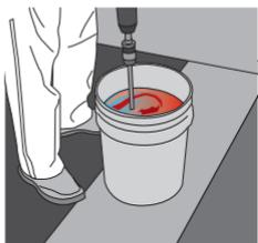
Mezcla los **componente A y B** con taladro de bajas revoluciones por 3 minutos, sin agregar burbujas a la mezcla.
