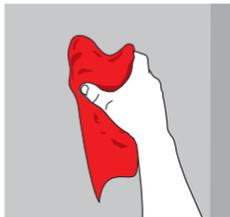
La superficie debe estar nivelada, limpia, libre de polvo, grasa o cualquier material que impida la adherencia del producto. Para aplicaciones sobre cerámica existente, debe realizarse una buena limpieza y el retiro de cualquier material que pueda interferir con la adherencia del **SikaCeram®-250 PSP**.
