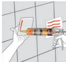
Aplica **SikaBond®** en la cara a fijar, el espesor del adhesivo puede variar entre 2 y 3 mm, dependiendo de la rugosidad del material.
