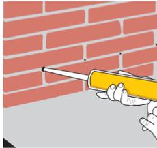
Inserte **SikaMur® Injecto Cream-100** en cada perforación, hasta llenarlo completamente.
