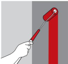
Imprimación de la superficie con **Sika Bonding Primer** + 5 % de agua, se coloca con rodillo o airless
