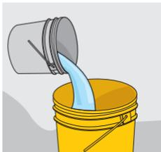
En un recipiente de boca ancha vierte el agua de mezcla conforme a la consistencia a aplicar\*.
