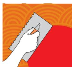
Finalmente, aplica una segunda capa de mezcla (aprox. de 1.5 cm espesor) preparada 1 a 3 (cm : arena) y la dilución de **Sika®-1**.
