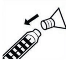
Después de la aplicación del material en los puertos de inyección, retire la punta fina de la boquilla de mezcla cuadrada y ajusta la espátula plástica en la punta de la boquilla de aplicación para sellar la grieta en el sustrato y entre los puertos de inyección.
