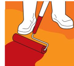
Aplicar una 2da. capa de **Acril Techo®-005 Iron Home** perpendicular a la 1ra. a razón de 0.5 mm por capa.
