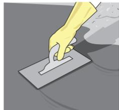
Deja reposar la mezcla por 1 minuto y vierte el producto sobre el sustrato previamente imprimado con Sikalutex N diluido en agua 1:2, extendiéndolo al espesor deseado con llana dentada o escantillón. Pasa inmediatamente un rodillo de puntas para sacar el aire atrapado.
