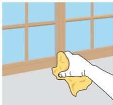
Limpia la superficie o bordes de la junta o unión dejándola secar. No debe tener restos de polvo o material desprendido.
