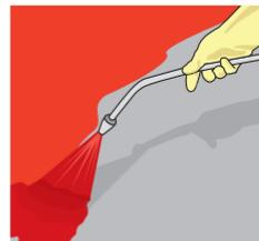
Después de aplicar realiza el acabado y afinado. Cura con **SikaCurador® E**. 21 días después se recomienda recubrir con **Sikafloor® Uretano Premium** transparente.
