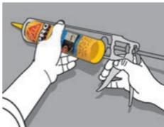
Coloca el fondo de junta **SikaRod®** del ancho adecuado a todo lo largo. Corta la boquilla del cartucho dependiendo del ancho requerido. Perfora la membrana de protección, colócalo en la pistola de calafateo y aplícalo.
