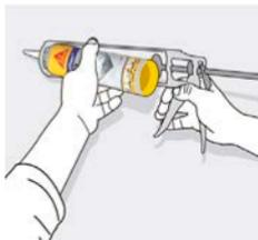
Corta la boquilla en 'V', aplicar el cordón del adhesivo de forma triangular (8 mm de ancho, 10 mm de largo). Instálalo en la pistola de calafateo.
