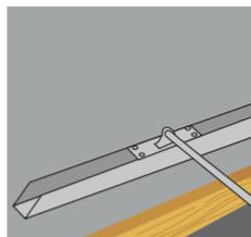
**Sika® Level 125** se acomoda con escantillón y llana dentada para detalles.
