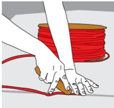
Introduce **Sika®Rod** dentro de la junta presionando de forma uniforme a una profundidad entre 6 y 12 mm. Cuidando respetar el factor forma de la junta.
