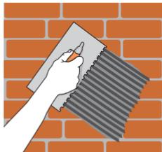
Aplica con llana metálica lisa, de abajo hacia arriba. En mortero adhesivo, aplica con llana dentada.
