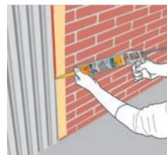
Rellena la junta con **SikaHyflex®-150 LM** evitando atrapar aire y la formación de burbujas.
