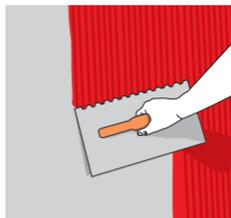
Aplica con llana metálica antes de que pasen 20 min.
