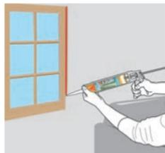
Aplica un cordón del producto mínimo 6 mm de lado en la junta o unión. Resane mínimo 2-3 mm.
