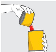
Si deseas un acabado con color, utiliza **Sikafloor® UreColor**. Poner 2 o 3 latas al componente A del **Sikafloor® Uretano Premium** (resina) antes de mezclar con el componente B.
