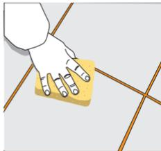
Se aplica con una llana de goma asegurándose de llenar uniformemente el ancho de la junta. Cuando el producto comience a fijarse apriete una esponja empapada en agua sobre la superficie de la boquilla para la limpieza.
