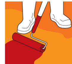
Aplica dos capas de **Acрил Techo® 5 Ultra** sin diluir en toda la superficie con un mínimo de espesor de 0.5 mm por capa y déjalo secar de 12 a 24 horas.
