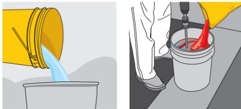
Coloca 3.5 L de agua en una cubeta limpia y agrega **Sika Monotop®-713 NM** gradualmente mientras mezclas con taladro de bajas revoluciones. Una vez incorporado todo el producto mezcla al menos 3 minutos más.
