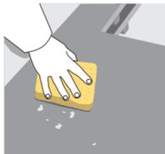
Limpia la superficie, debe estar seca y sin restos de polvo o material desprendido. Si existen fisuras sobre la superficie, deberán de sellarse utilizando **Permalastik®/ Sika Permalastik® Pro** a lo largo de la fisura.
