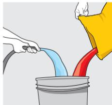
Mezcle un saco de SikaCeram®-252 Pool con 4.0- 4.6 L. de agua. Mezcle por 3 min. y deje reposar por 5 min.
