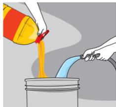
Diluye una parte de **Sika®-1** por 10 partes de agua y utilízalo como agua de mezcla.
