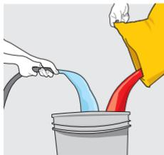
Mezcle un saco de **SikaCeram®-250 PSP** con 4.5- 5 Litros de agua. Mezcle por 3 minutos y deje reposar por 5 min.
