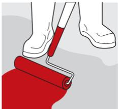
Coloque con rodillo o con airless 2-3 capas de **Sikaguard®-62**.
