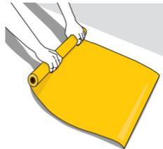
Colocar **Sikabit® S-515 SGMX Acoustic**, retirando el film protector de la cara adhesiva, ayudarse de un rodillo para mejorar la adhesión. La cara lisa quedará hacia el lado expuesto haciendo impermeable la estructura.
