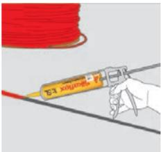
Rellena la junta evitando atrapar aire. Es necesario que la profundidad de la junta sea entre 6 mm y 12 mm.
