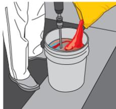
Mezclado de **Sika®Level-325**, adicionar el 18% de agua (4.5 L).
