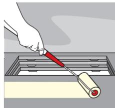
Aplica una capa uniforme de **Sika® Desmoldante Constructor** o **Sika® Desmoldante MX** sobre la cimbra, puedes aplicarlos con brocha, rodillo o aspersor genérico para obtener mayor rendimiento. Apicalos inmediatamente antes de colar o varios días antes.
