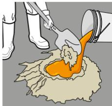
Utiliza la dilución como agua de mezcla para un mortero preparado con 1 volumen de cemento por 2 de arena.
