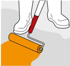
Para impermeabilización: usar como primer **Acril Techo® 3 PRO** diluido con agua 3:1 capa de .6 lts/m<sup>2</sup>.
